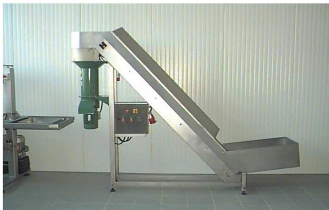
Les fruits sont lavés sur la bande transporteuse grâce à plusieurs jets d'eau haute pression, permettant ainsi l'utilisation de fruits souillés.
